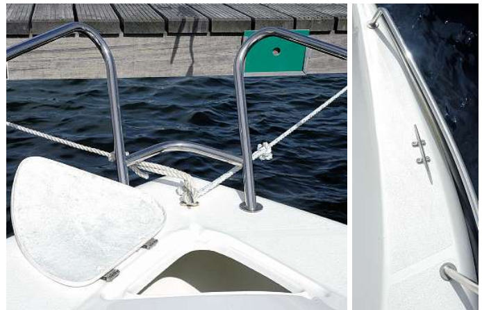
Am Ankerkasten wurde ein Wasserablauf eingespart. Die vorderen Gangborde sind für ein 18-Fuß-Boot ungewöhnlich breit
