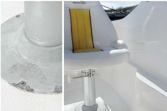
Unschön: Korrosionsspuren an der Aufnahme des Stuhlbeines. Ein sehr praktisches Detail ist die seitliche Ein- und Ausstiegsstufe
