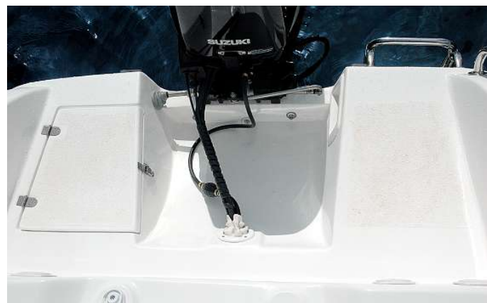
Zu beiden Seiten der Motorwanne befinden sich strukturierte Trittflächen, steuerbords ist zudem ein Staukasten eingelassen
